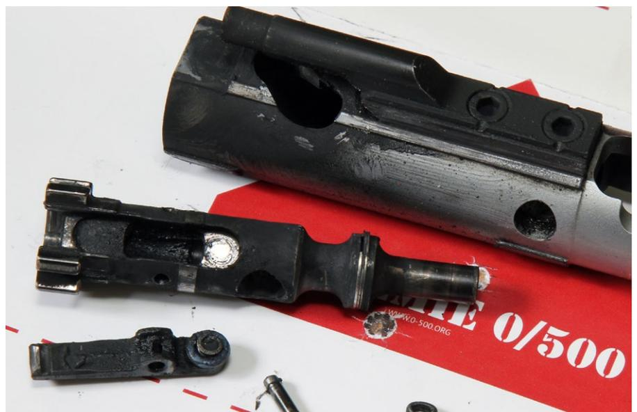
Bei jeder zweiten Detailreinigung sollte die Ausziehkralle am Verschlusskopf entfernt werden, um den Schlagbolzenkanal zu säubern. Auch die Ausziehkralle selbst sollte von Messingresten und Schmauch befreit werden
