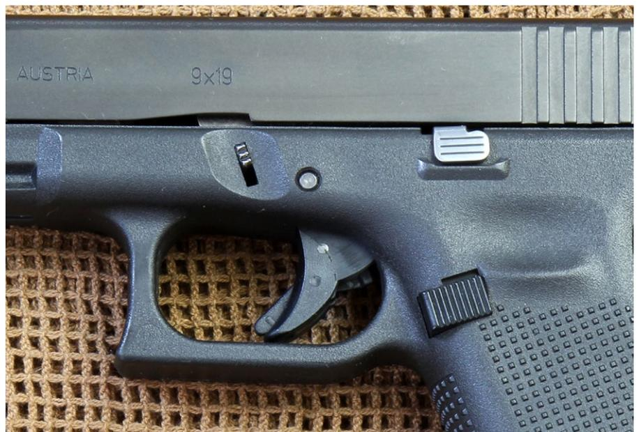
Der Schliff an der linken Seite des Abzugszüngel ist das Resultat eines Abzugsfehlers. Der Abzug wird beim Abkrümmen jedes Mal mit etwas Druck nach links bedient
