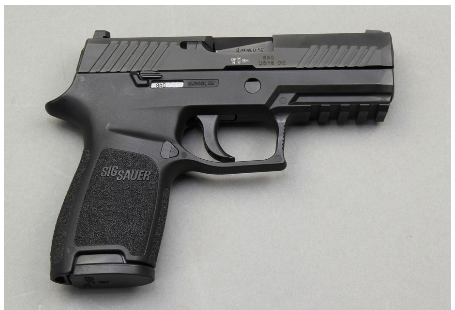
Das Griffstück besitzt keine Seriennummer. Diese ist lediglich in der Abzugseinheit eingraviert
