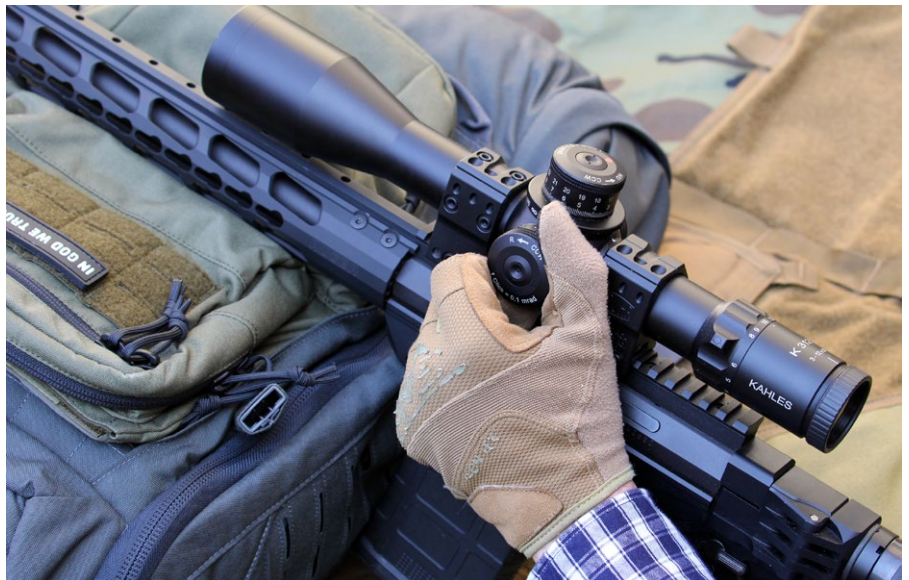
Bei ccw-Drehrichtung bedient die linke Hand die Türme, dreht aber dennoch „zur Daumenspitze“. Das Resultat bleibt identisch, da es eine Korrektur nach oben bzw. nach rechts bewirkt
