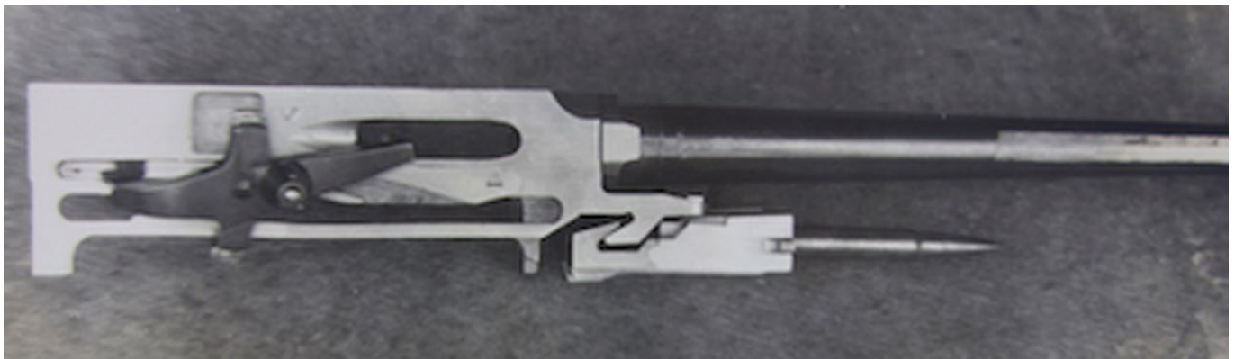
Prototyp des Folge Modells, dem Fmg W-2. Die Firma C.G. Haenel hatte die Herstellungs- und Verwertungsrechte an dem Waffenmodell erworben und wohl mindestens ein Waffenmuster im Kaliber 8 x 57 IS gebaut
