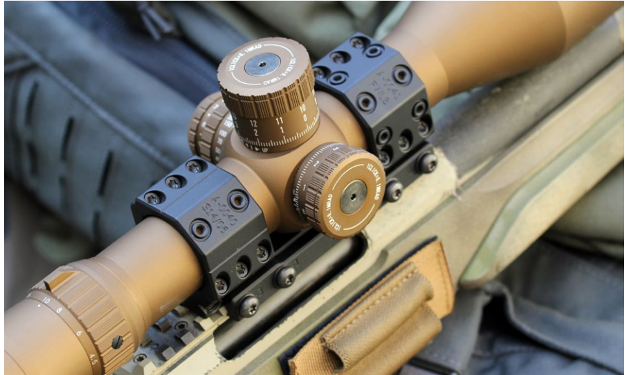
Typisch US-amerikanische Turmkonfiguration: ccw-Drehrichtung. In diesem Fall allerdings keine MOA-Rastung, sondern 0,1 mrad (1-cm-Klickverstellung)
