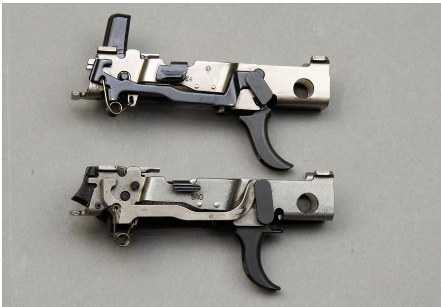
Oben die Abzugseinheit der P250 Double Action Only (DAO). Unten die der P320. Der Schlittenfanghebel wurde noch einmal verkleinert
