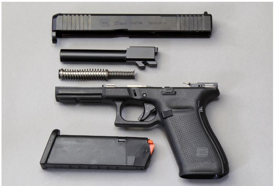
Feldmäßig zerlegt. Der trichterförmige Magazinschacht und die sog. „front serrations“ sind Merkmale, die man nicht vermissen würde, wären sie nicht vorhanden
