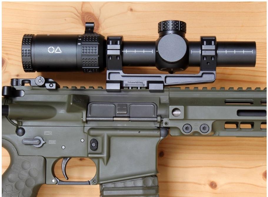
Zielfernrohre sollten beim AR-15 so weit wie möglich nach vorn montiert werden
