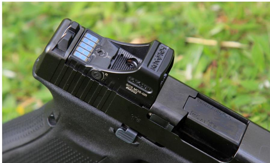
Die Solarzellen versorgen das batterie-lose SCS mit Energie
