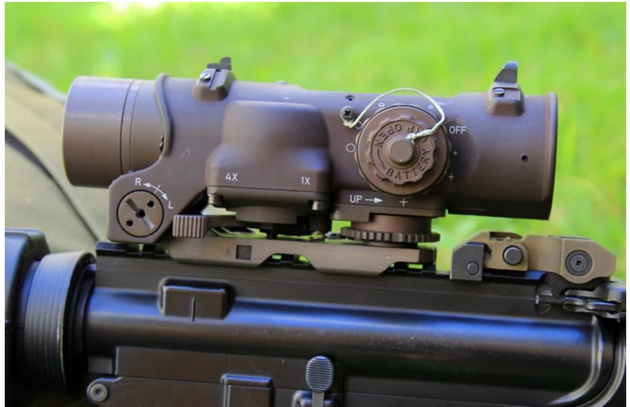
Die Seitenverstellung befindet sich am Gerät vorn und kann mit einer Münze oder Patronenhülse bedient werden. Das Stellrad für die Höhe ist ohne Werkzeug handhabbar. Es kann über eine Sperrklinke fixiert werden. Der Umschalthebel von 4x zu 1x ist intuitiv mit dem Daumen bedienbar.
