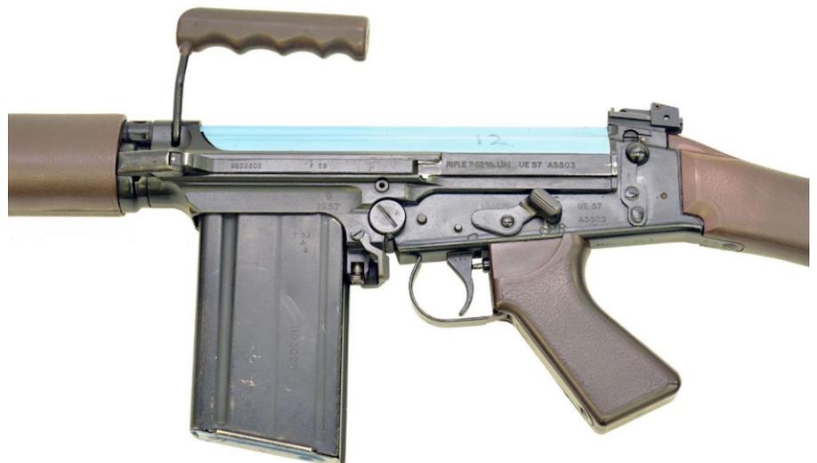
Für die Force-on-Force-Ausbildung umgerüstetes L1A1 mit blauem Gehäusedeckel und Bauteilen aus Malanyl. L1A1-Magazine sind an der dreifachen Markierung mit Seriennummer von anderen FAL leicht zu unterscheiden (Foto: Royal Armouries)
