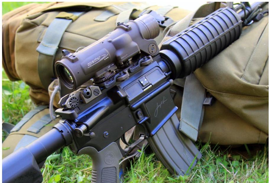
Bei ELCAN Zielloptiken ist eine Spannmontage von ARMS grds. inkludiert. Bei einem Zielfernrohr müsste sie extra beschafft werden. Die Sperrklinke der Höhenverstellung ist im Bild entriegelt.
