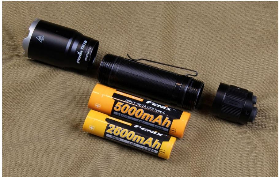
Der größere 21700 Akku kommt mit einer Leistung von 5.000 mAh; im Gegensatz zu den 2.600 mAh des 18650 (unten)
