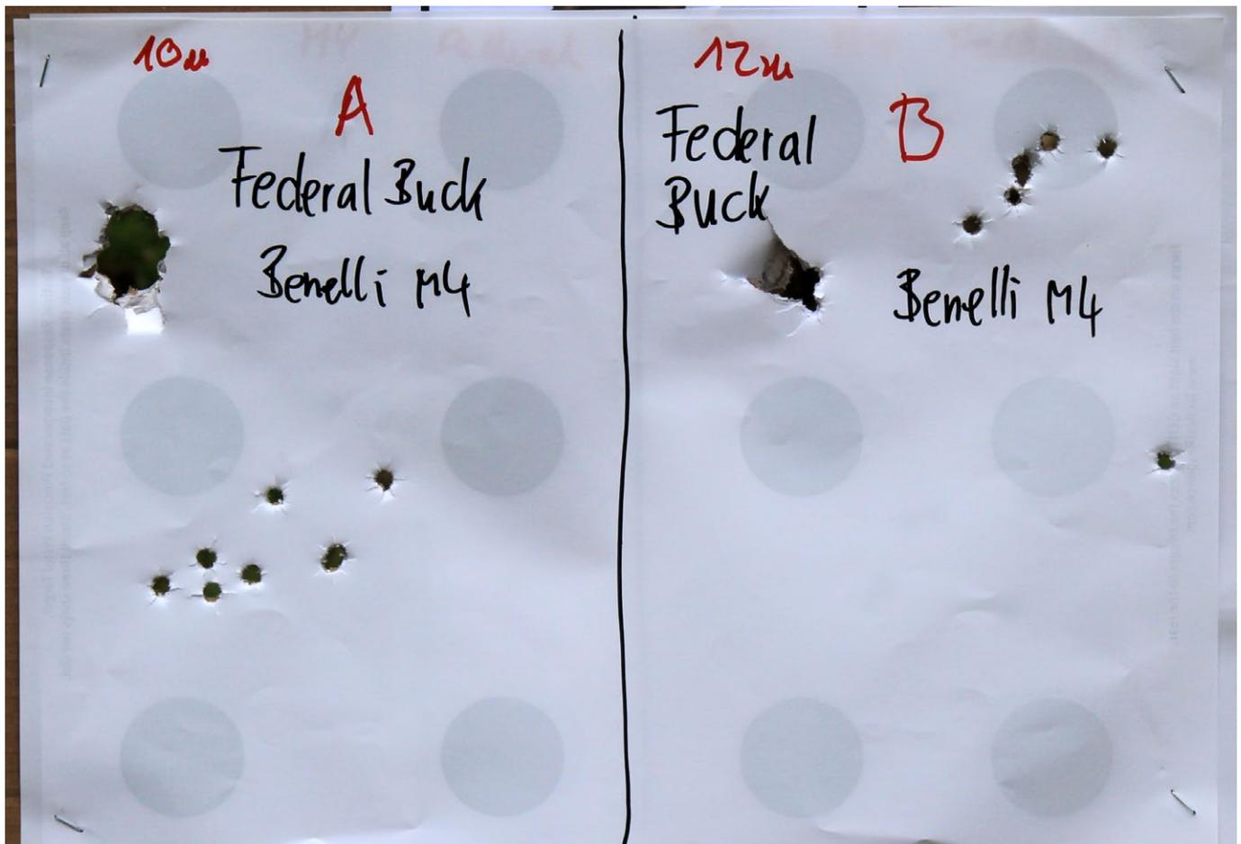
Die Laborierung Tactical Buck Shot von Federal ist bekannt für kleine Gruppen. Wodurch die Zone B mitunter bis zu 18 Meter ausgedehnt werden kann
