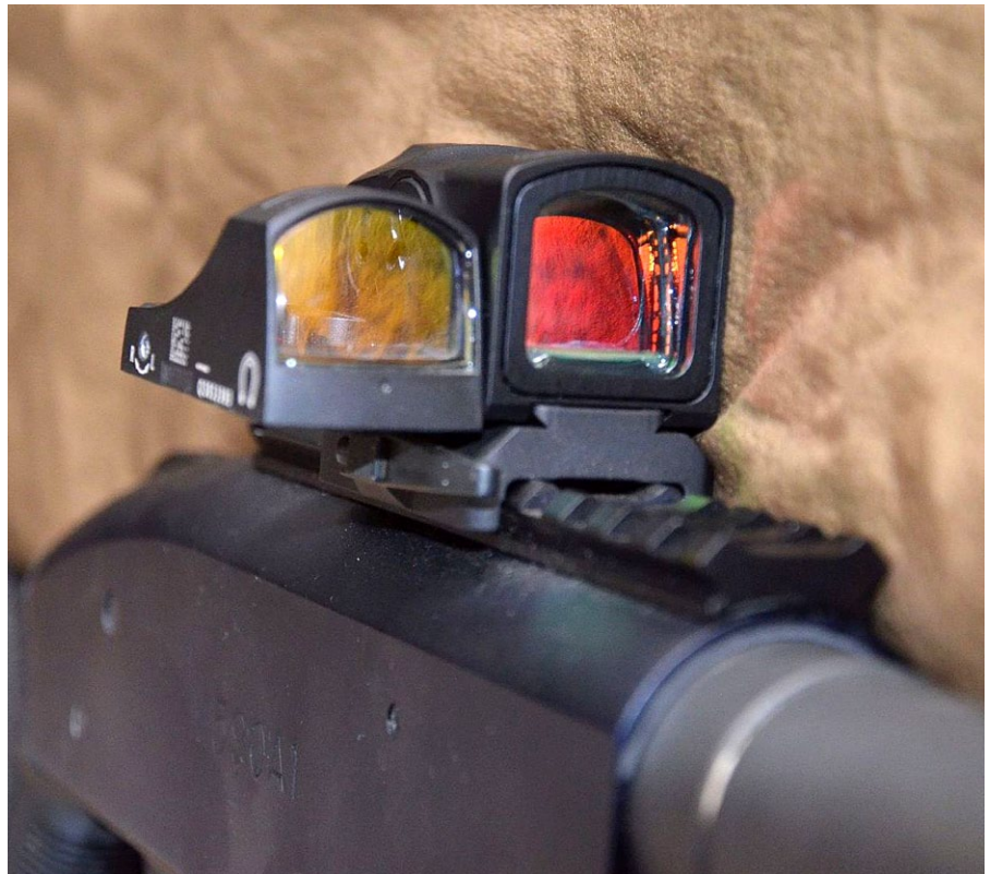
Beim ACRO P-1 sitzt der Großteil der Technik seitlich im Visier statt unter der Linse. Das erlaubt trotz schützendem Rahmen einen tiefen Sitz auf der Montage
