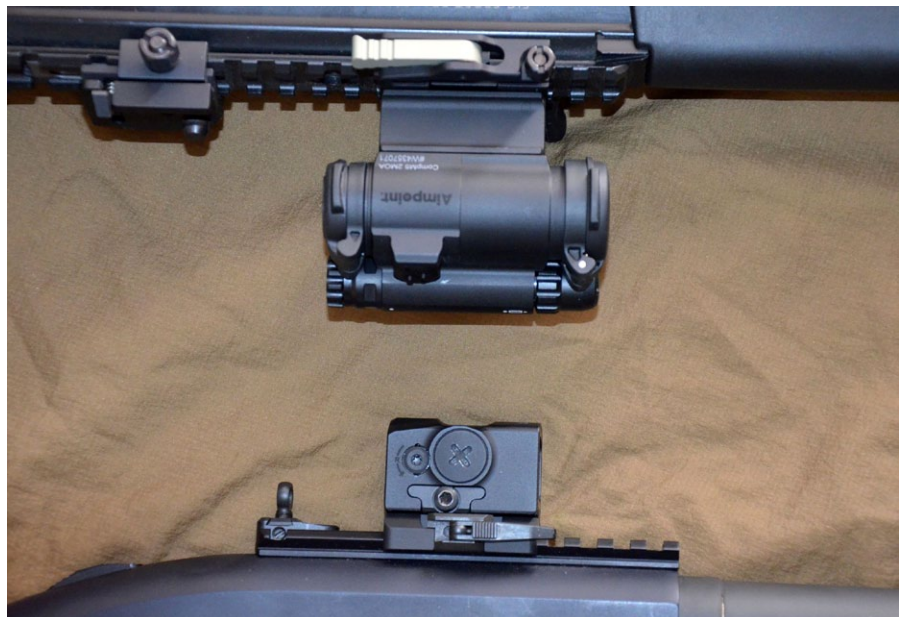
Das ACRO P-1 ist weniger als halb so lang wie das Comp M5 und wiegt etwa ein Drittel bei vergleichbarem Sichtfenster (18 Millimeter Durchmesser beim M5, 16 Millimeter Kantenlänge beim ACRO)
