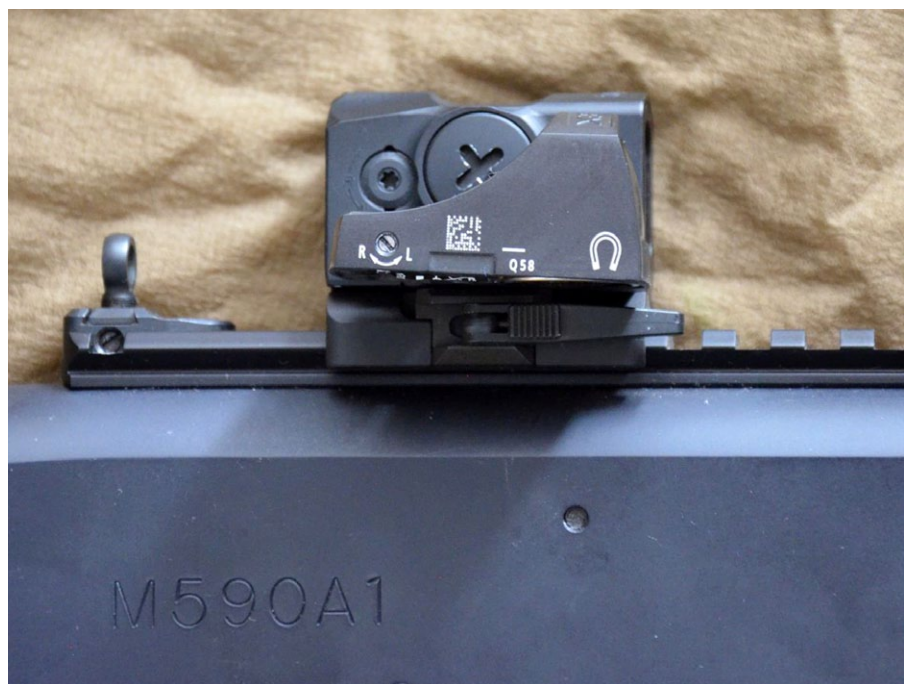
Je nach Montage beginnt das Sichtfenster des Noblex Sight höher über der Waffe und es ragt insgesamt höher über die Schiene als das ACRO P-1
