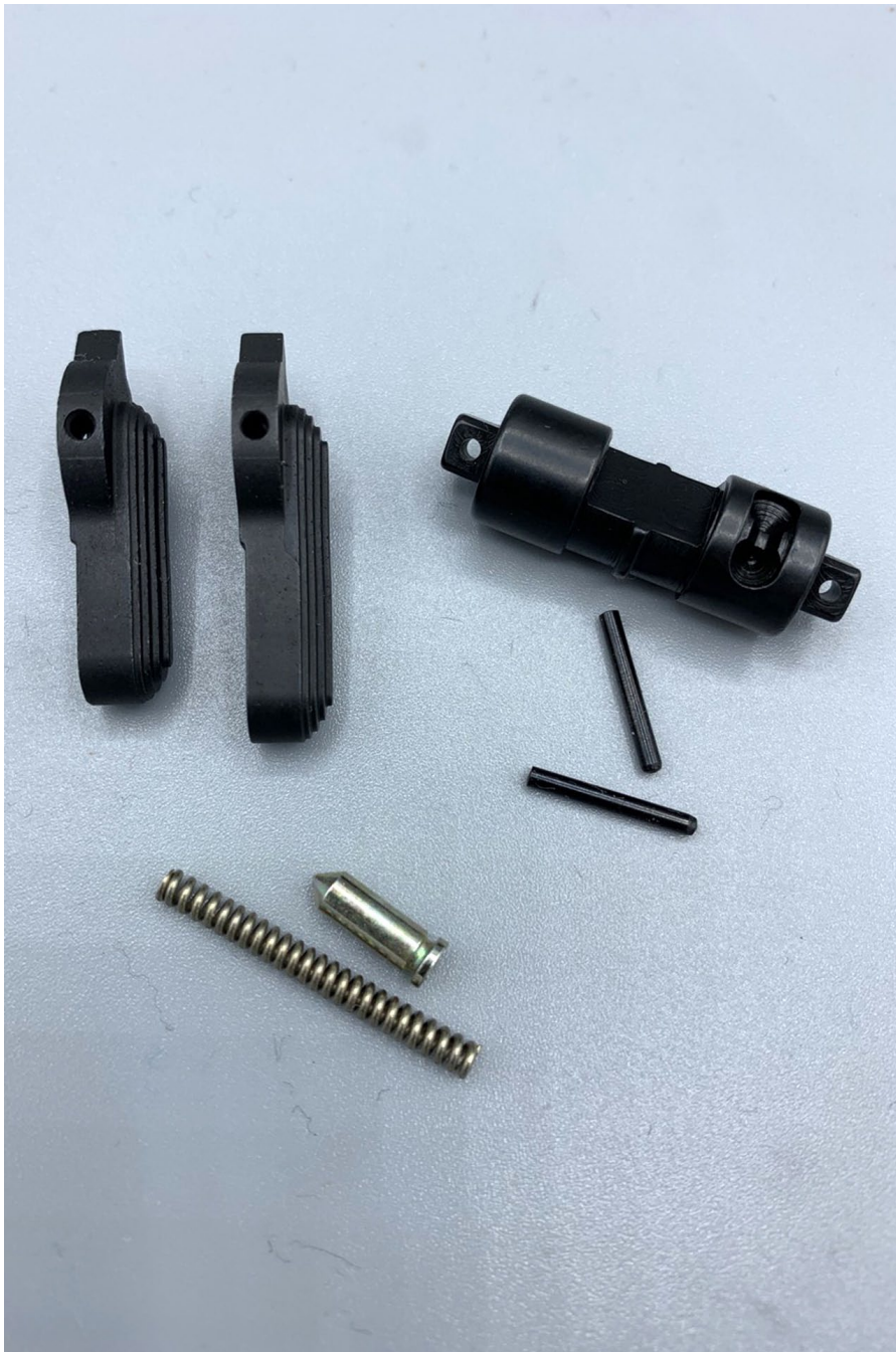
Die Bauteile der doppelseitigen Sicherung. Zu erahnen ist die konische Bohrung der Sicherungshebel durch die unterschiedlichen Durchmesser der beiden sichtbaren Bohrlöcher
