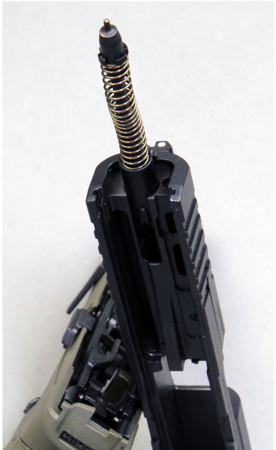
Zum Zerlegen des Schlagbolzens kann der Verschluss behelfsmäßig als Werkbank genutzt werden
