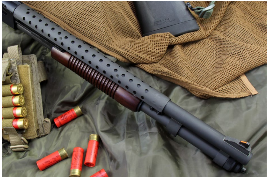
Der Hitzeschutz über dem Lauf erhöht das Gewicht etwas und sieht martialisch aus
