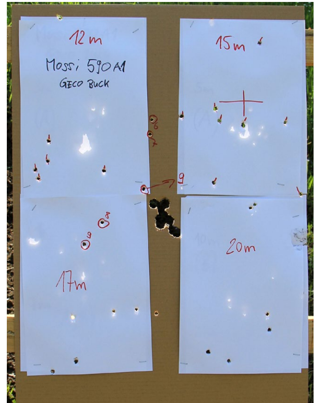
Wirkungszonen: Die gewünschte Wirkungszone B beginnt bei der Mossberg 590 A1 bei Verwendung von GECO Postenschrot bei sieben Meter und endet bei etwa zwölf Meter
