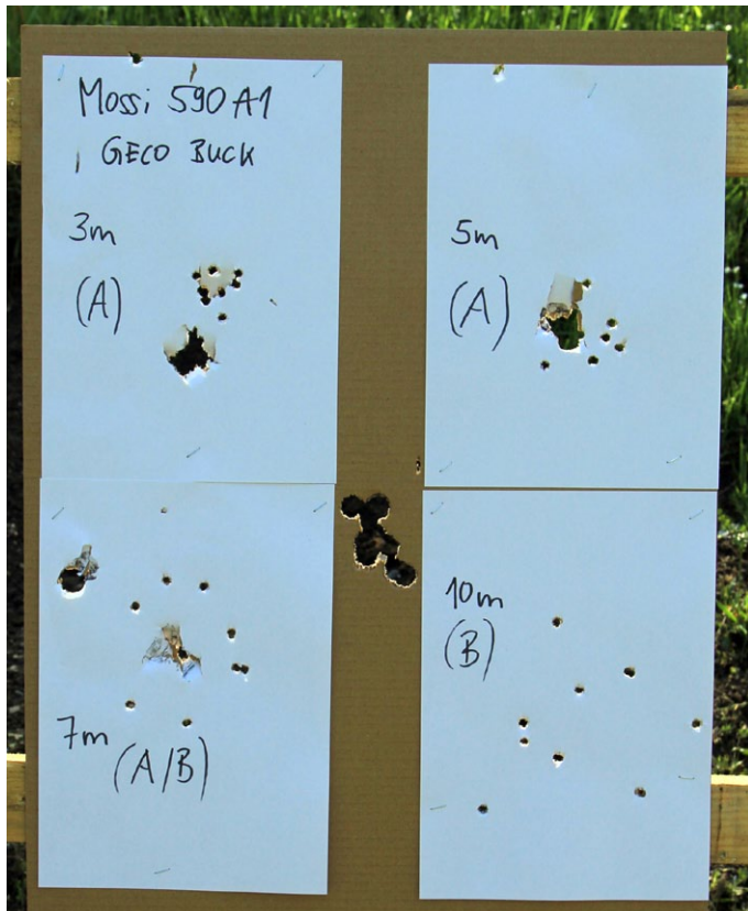
Wirkungszonen: Die gewünschte Wirkungszone B beginnt bei der Mossberg 590 A1 bei Verwendung von GECO Postenschrot bei sieben Meter und endet bei etwa zwölf Meter
