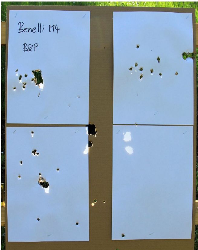
Bei der Benelli M4 mit Postenschrot des Herstellers B&P liegt die B-Zone gerade einmal zwischen fünf und sieben Metern. Zu wenig für einen effizienten Einsatz. Der Teilnehmer folgte hier der Munitionsempfehlung seines Händlers
