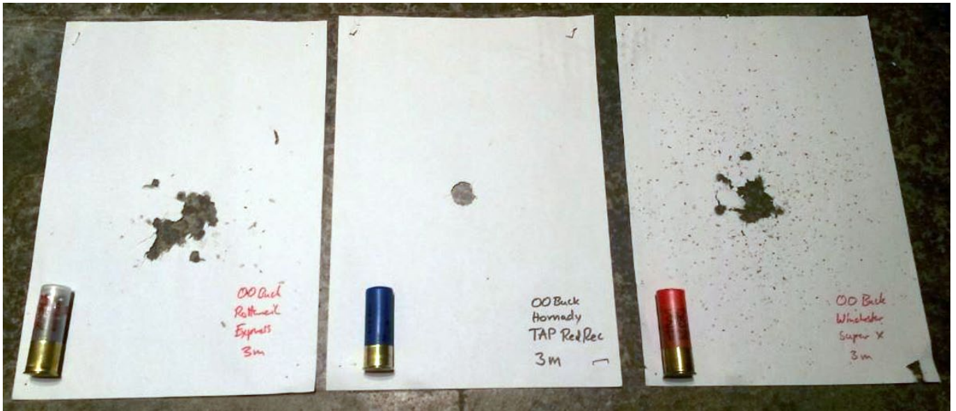
Während Rottweil Express und Winchester Super X beide bei knapp über fünf Prozent Trefferfläche liegen, erzeugt die Hornady TAP mit unter einem Prozent die kleinste Gruppe des Versuchs. Man beachte die enorme Sekundärwirkung durch unverbranntes Pulver bei der Super X-Patrone.
