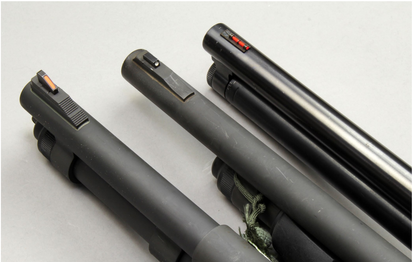
Mossberg Visieroptionen: Die 590A1 Retrograde besitzt ein Korn mit orange-farbigem Inlett (links). Möglich ist bei den 590 Modellen auch eine Büchsenvisierung. Die Mossberg 500 (rechts) besaß ein Perlkorn, das gegen Fiberglas orange ausgetauscht wurde
