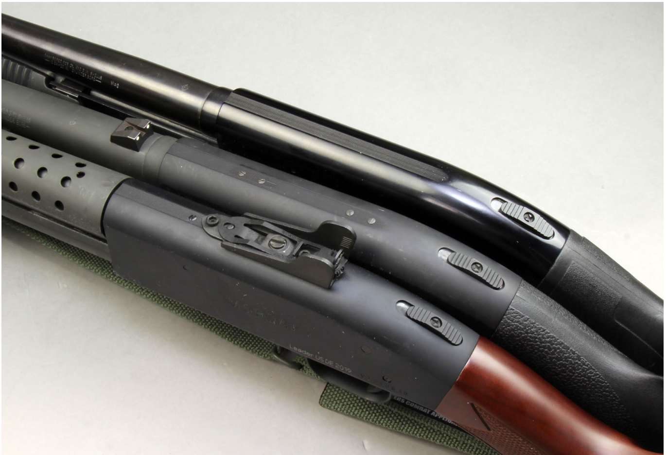
Die 590A1 Retrograde kommt serienmäßig mit dem Mossberg Ghost Ring Visier. In der Mitte die Kimme der 3-Punkt-Büchsenvisierung. Die Mossberg 500 besitzt außer dem Perlkorn keine weitere Visiereinrichtung
