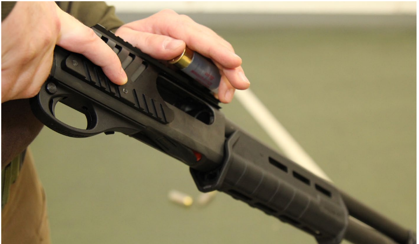
Beim administrativen Laden wird die erste Patrone immer direkt über das Auswurffenster zugeführt
