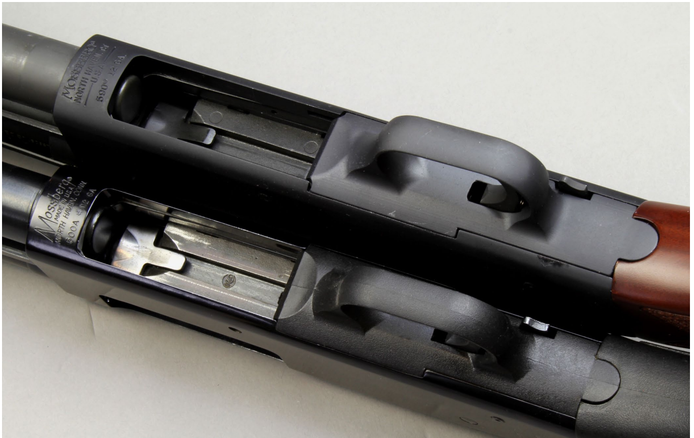
Abzugsbügel und Sicherungsschieber sind bei der 590A1 (oben) aus Aluminium. Bei der 500 und 590 hingegen sind diese Kleinteile aus Kunststoff
