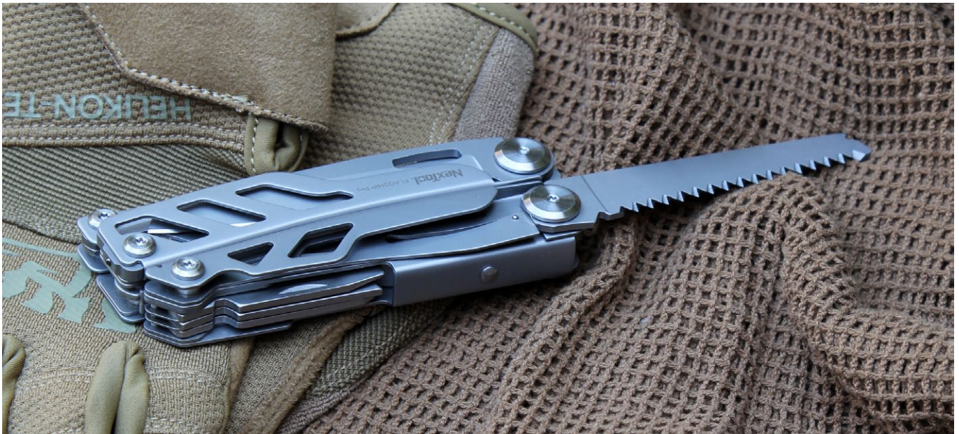
Im Gegensatz zur Klinge arretiert die Säge über eine Sperrklinke
