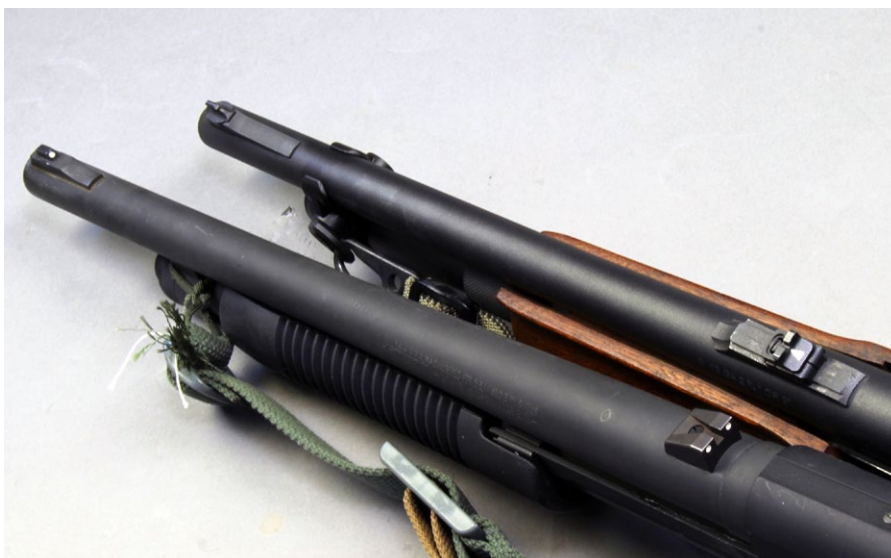
Eine einfache Büchsenvisierung auf dem Lauf reicht für die meisten Einsatzzwecke aus. Riemenaufnahme per Fallschirmschnur oder über eine CNC-gefräste Öse: Das bleibt dem Anwender freigestellt
