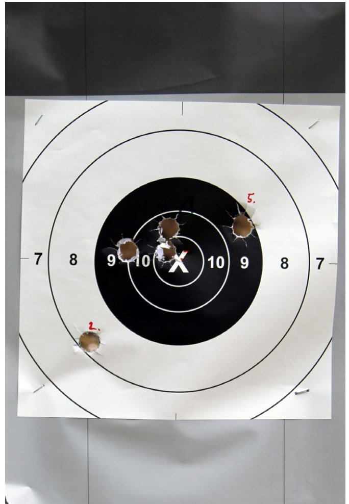
Trefferbild der Benelli M3, offene Visierung bis 50 Meter. Schuss Nr. 2 links tief geht auf das Konto des Schützen
