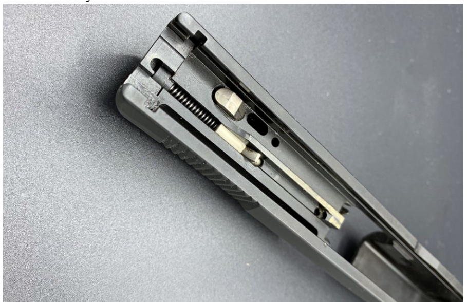
Innenansicht des Verschlusses. Gut zu sehen sind der Schlagbolzen sowie die Steuerfläche der Schlagbolzensicherung
