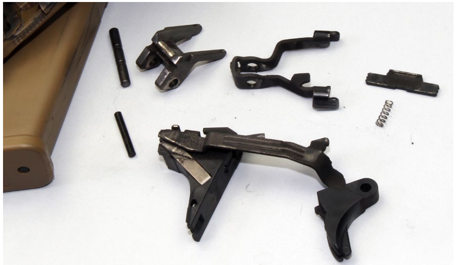
Das Griffstück komplett zerlegt. Die Abzugsgruppe ist stark verschmutzt
