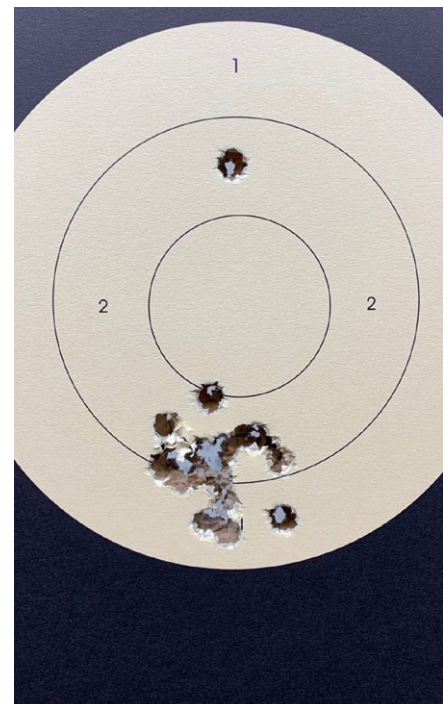
Tiefschüsse auf sieben Meter bei Haltepunkt Zielmitte mit Oberkante Korn. Der Ausreißer geht auf das Konto des Schützen
