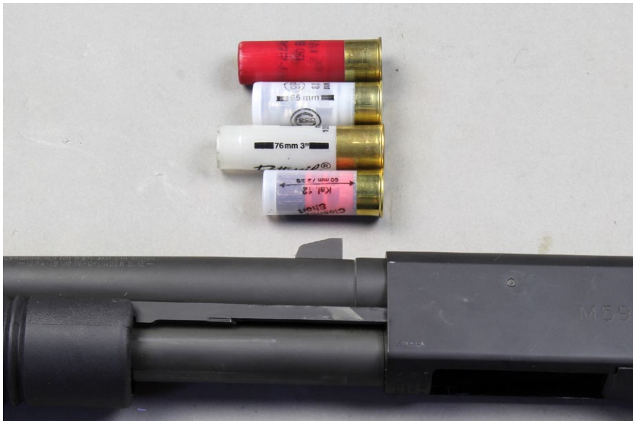
Kürzere Ladungen (12/60 oder 12/65 oder ähnliches) führen zu Schmauchablagerungen im Patronenlager. Funktionsstörungen beim Verschuss von längeren Ladungen können die Folge sein
