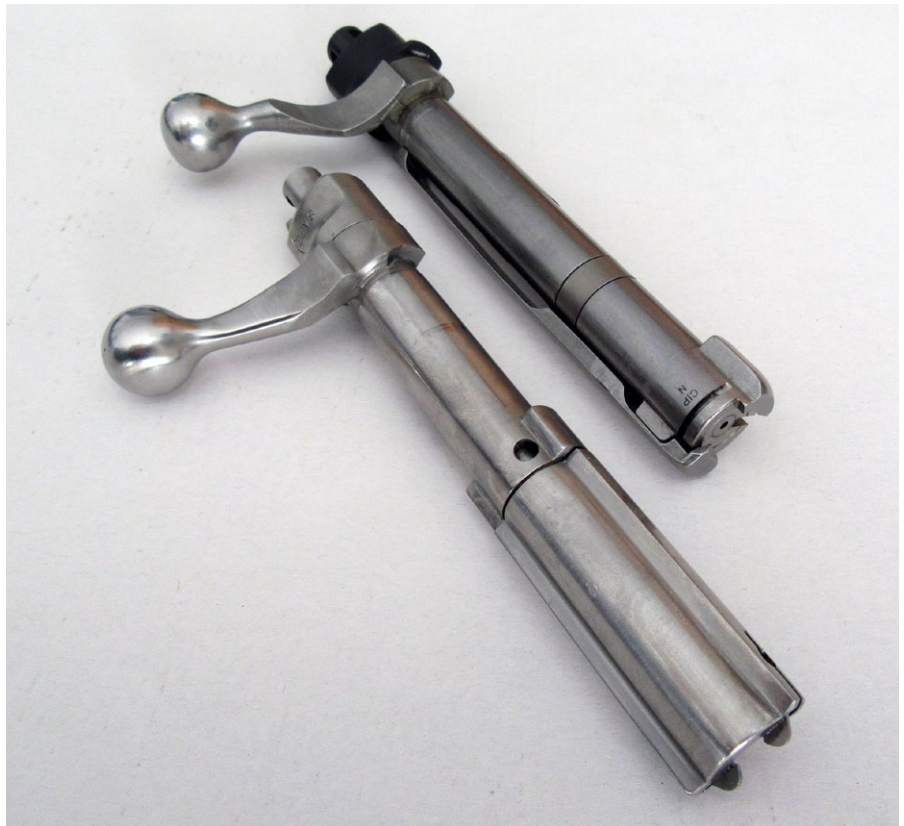
Auch der Verschluss des 77/22 (links) ähnelt in seinen Abmessungen stark dem des GSR (rechts). Während der vordere Teil ohne Drehung vor dem Patronenlager ruht, verriegelt der hintere Teil mit zwei großen Verriegelungswarzen. Die scheinbar zweite Kralle am Verschlusskopf dient nicht als weiterer Auszieher, sondern übt lediglich Gegendruck zu diesem aus
