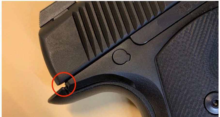
H9 „out of battery“ – immer wieder kam es im Test zu dieser Störung
