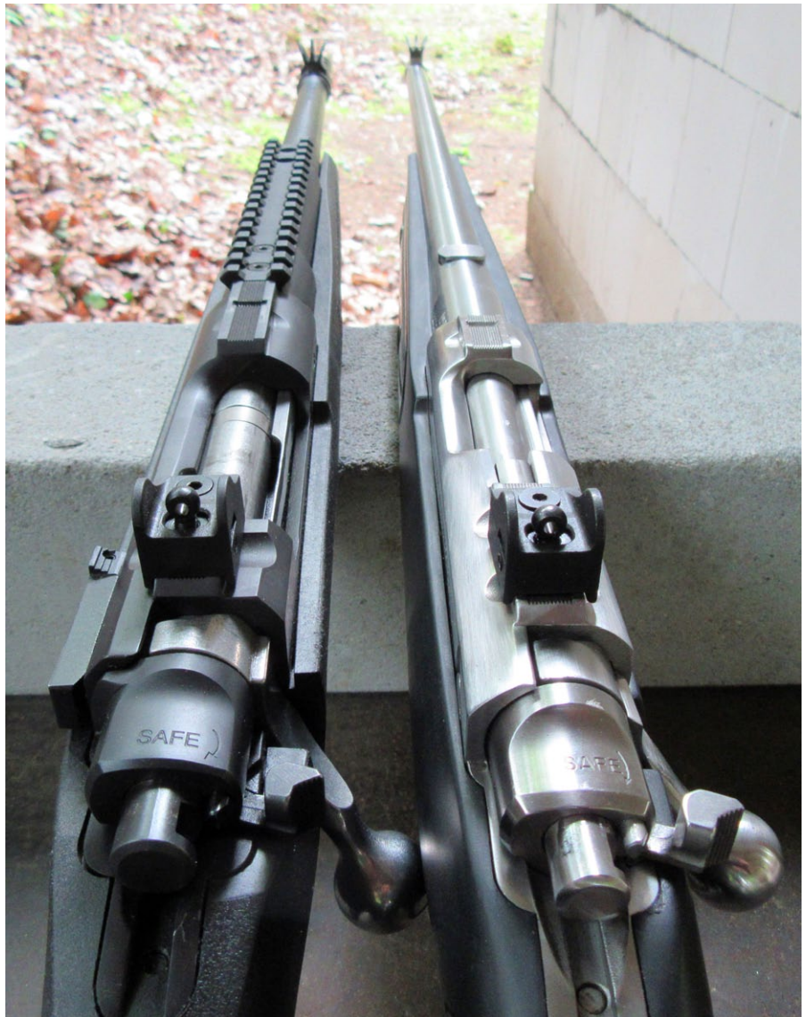
Mit geringem Aufwand und Kosten konnte die Eisenvisierung des 77/22 an die des GSR angeglichen werden. Der freigewordene Schwalbenschwanz wurde mit einem Blindstück verschlossen. Die Montage eines ZFs ist ebenfalls möglich
