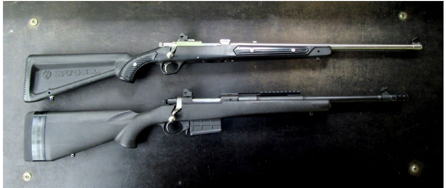
Das Ruger 77/22 (oben) ähnelt in seinen Abmessungen stark dem großkalibrigen Ruger 77 und damit dem Ruger GSR (unten). Nur der Lauf ist im Vergleich zum GSR zehn Zentimeter länger, was eine entsprechend verlängerte Visierlinie mit sich bringt
