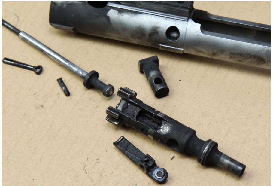
Bei diesem Verschmutzungsgrad lässt sich der Schlagbolzen beim Zerlegen kaum noch von Hand entfernen. Störungen sind vorprogrammiert
