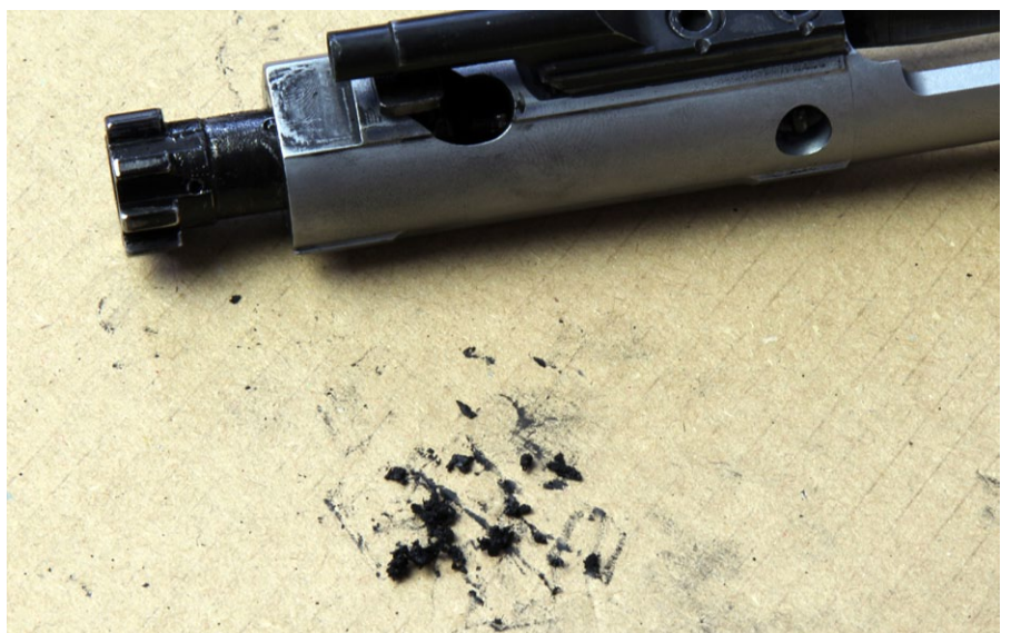
Es ist erstaunlich, wie viel Dreck in den Schlagbolzenkanal des Verschlusskopfes passt und das Black Label M4 dennoch störungsfrei funktionierte
