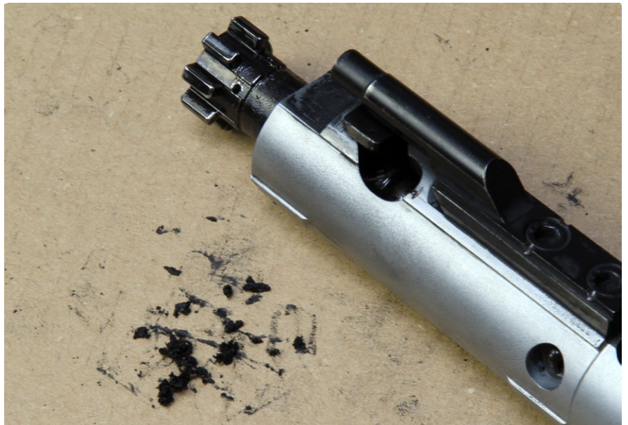
Es ist erstaunlich, wie viel Dreck in den Schlagbolzenkanal des Verschlusskopfes passt und das Black Label M4 dennoch störungsfrei funktionierte
