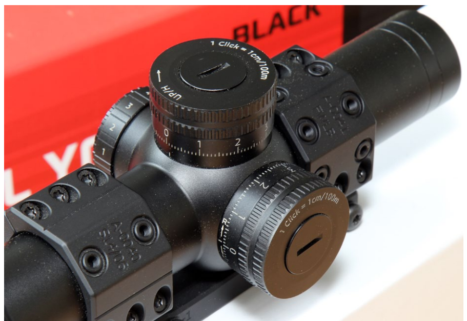
Die Türme arbeiten clockwise (cw) und in mil (1cm/100m). Die sog. „locking turrets“ müssen vorm Verstellen leicht angehoben werden
