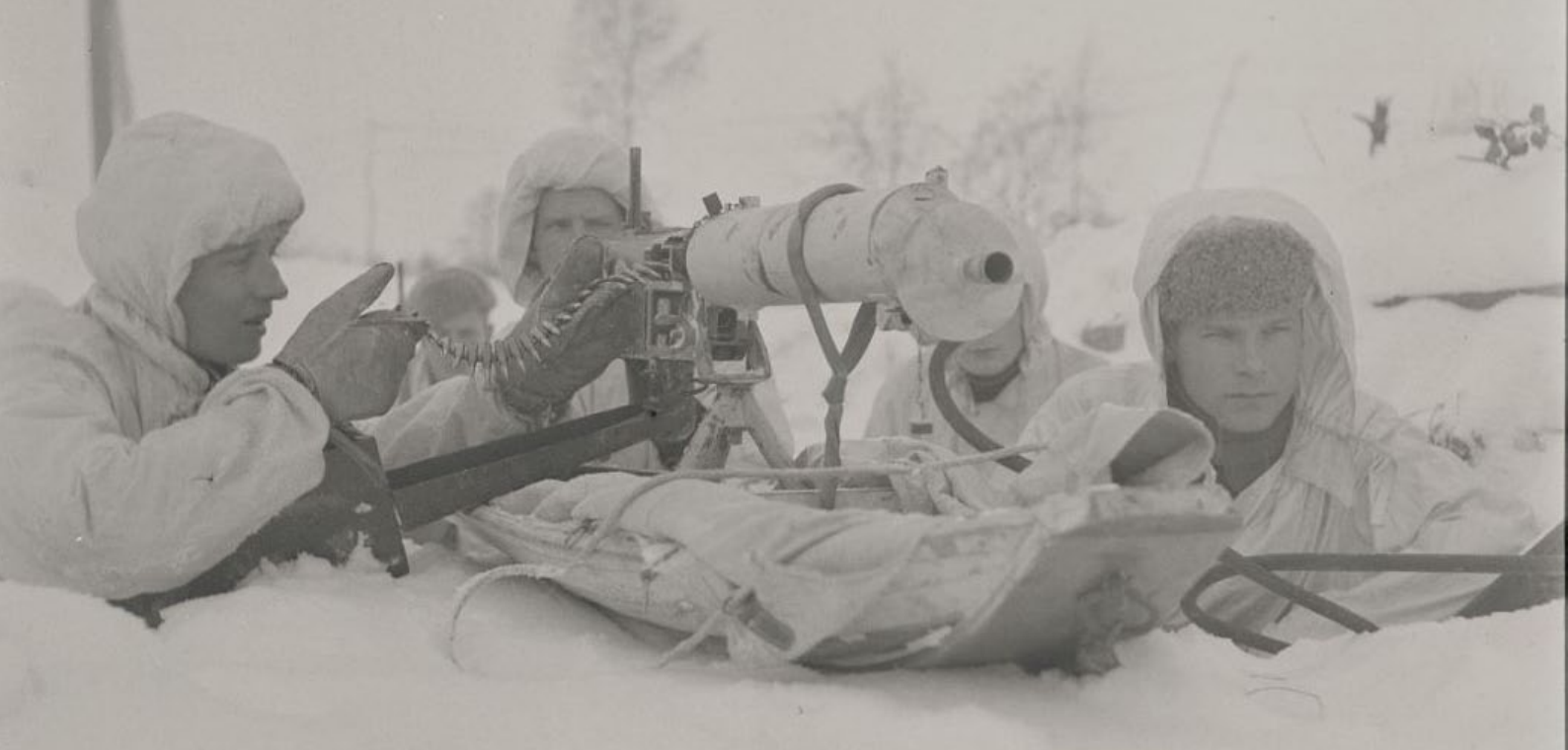
Ein finnischer Maschinengewehrtrupp mit einem Maxim M/32-33 (montiert auf Pulka) in Stellung - die finnische Version des Maxim-MG konnte durch eine Öffnung am Laufmantel mit Schnee gekühlt werden (SA-kuva).
