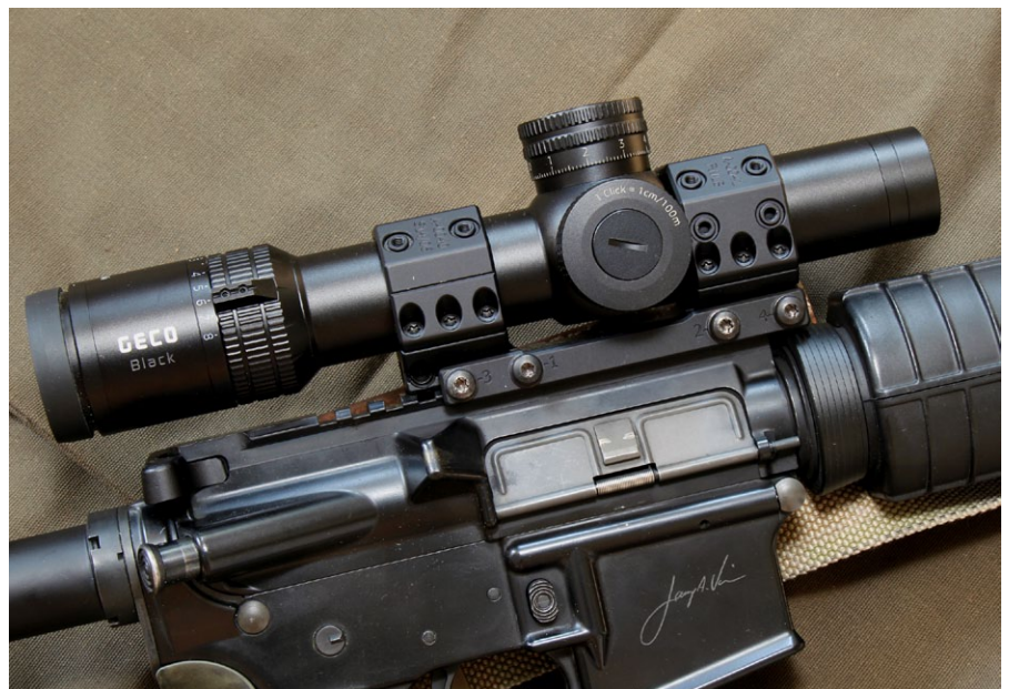
Für die Montage auf einem AR-15 ist eine gekröpfte Montage empfehlenswert (bspw. SPUHR SP-4016). Eine normale Blockmontage erzeugt nicht den notwendigen Augenabstand. Selbst dann nicht, wenn sie vorgeschoben (und unfachmännisch) montiert wird (Foto)
