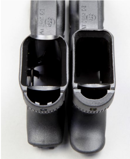
Der Magazinschacht der Gen. 5 ist trichterförmig und besitzt vorn eine Aussparung
