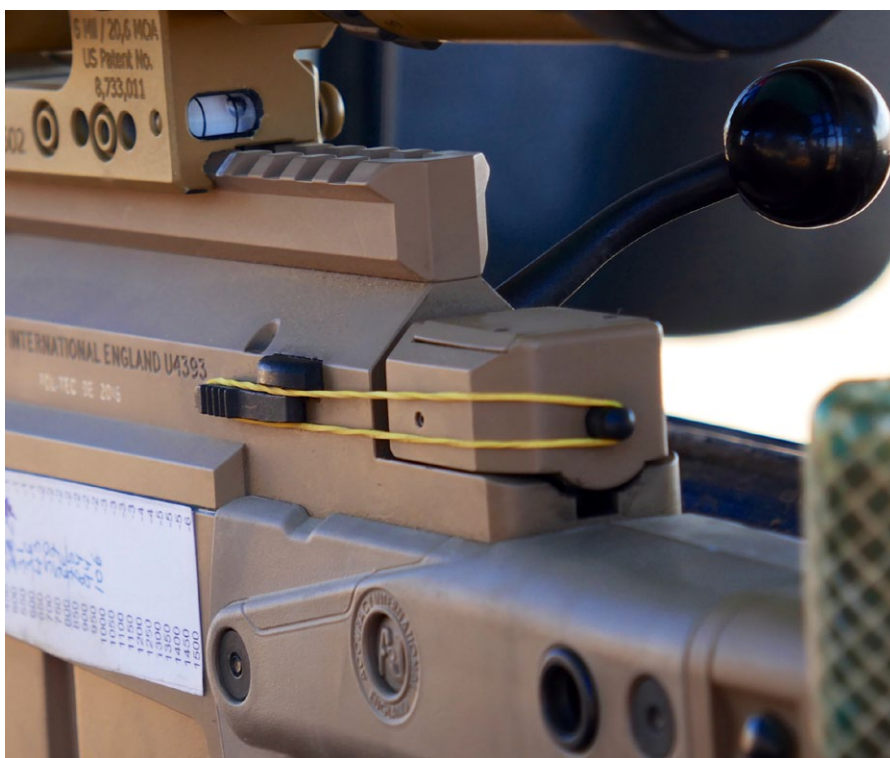
Spezial Verschlussicherung beim Transport mit offenem Verschluss
