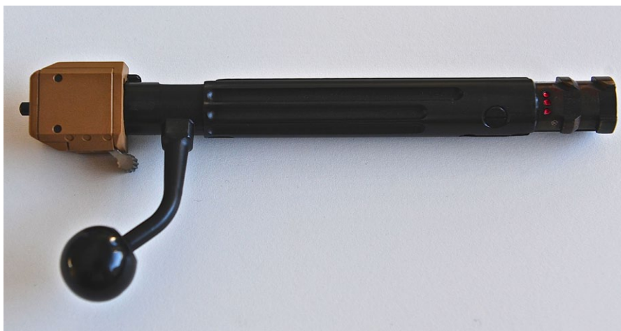
Verschluss in .338 Lapua Magnum mit Markierung (drei rote Punkte)
