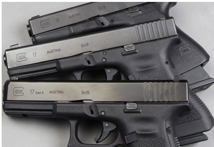
In der Gen. 3 erhielt der Verriegelungsblock einen zusätzlichen Sicherungsstift (Locking Block Pin). Bei der Gen. 5 hält, wie bei der Gen. 2 (oben), nur die Abzugsachse den Verriegelungsblock
