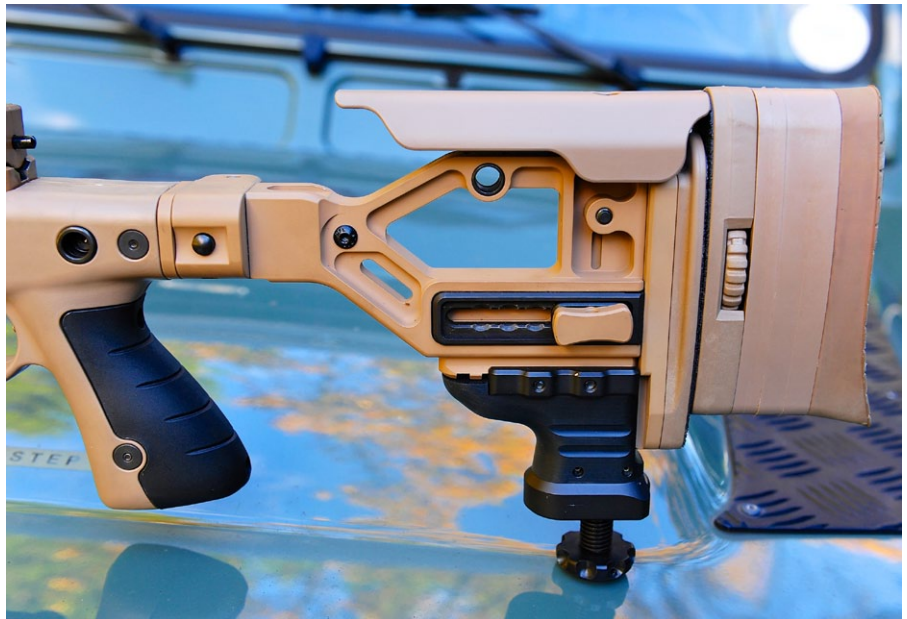
Schulterstütze, klappbar und verstellbar sowie Erdsporn
