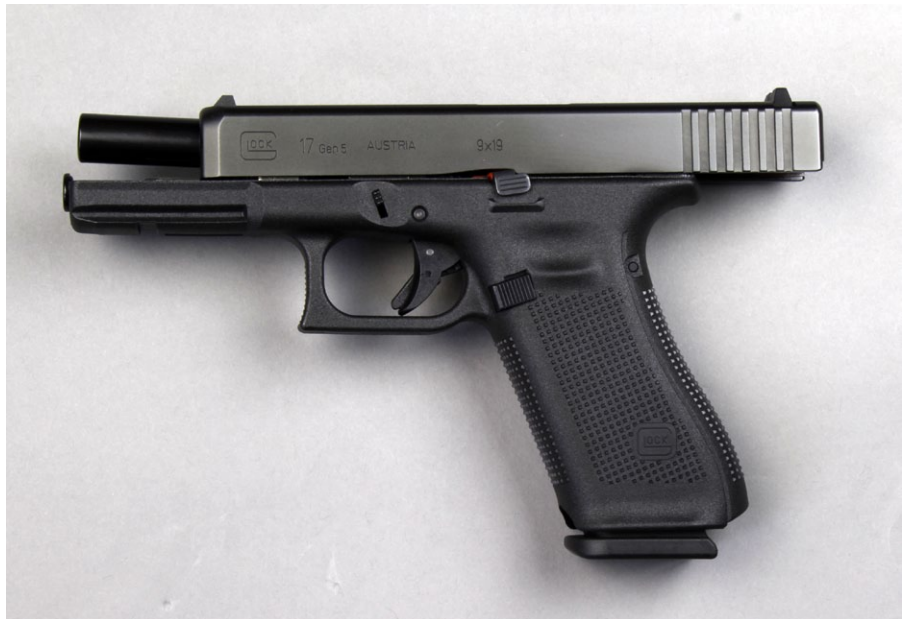
Die fehlenden Fingerrillen am Griffstück dürften das deutlichste Wesensmerkmal der Gen. 5 darstellen
