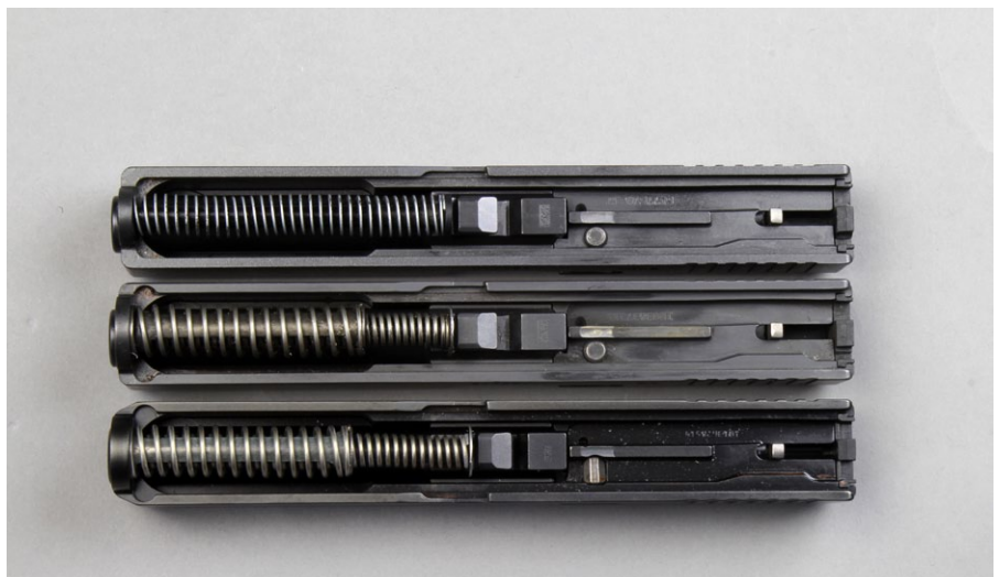
Die Zündstiftsicherung ist anders geformt. Bis zur Gen. 4 ist sie zylinderförmig. Die Schließfeder ist länger
