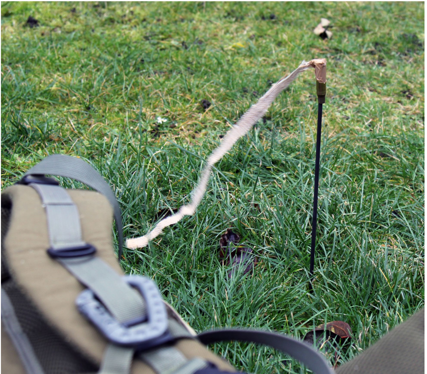
Stab, Patronenhülse, Sackleinen: Fertig ist die improvisierte Windfahne
