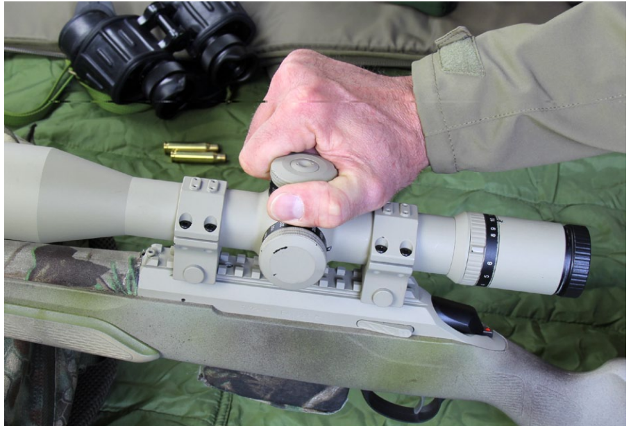
Standard-ZF und cw-Verstellrichtung: Dreht die rechte Hand zur Daumenspitze hin, bedeutet das eine Verschiebung der Treffpunktlage in den positiven Bereich (nach oben bzw. nach rechts)
