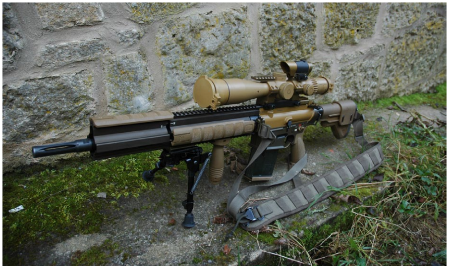
Das Zielfernrohrgewehr G28 wiegt geladen (mit Optik) etwa 8,1 Kilogramm (Foto: Autor).
