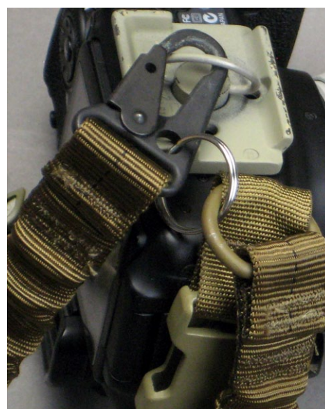
Modifiziert mit einem Schlüsselring ohne Kupplung. Der Riemen wird etwa 10 cm kürzer, die Kamera hängt höher am Körper
