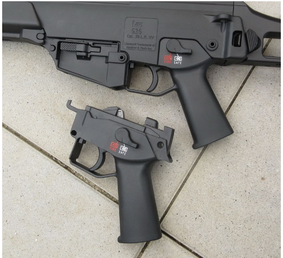
Links am Griffstück der Verschlussfang
