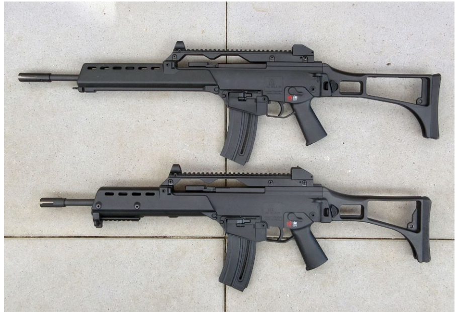
Obere Waffe mit geändertem Vorderschaft des G36. Untere Waffe mit gekürztem Lauf und kürzerem Hinterschaft
