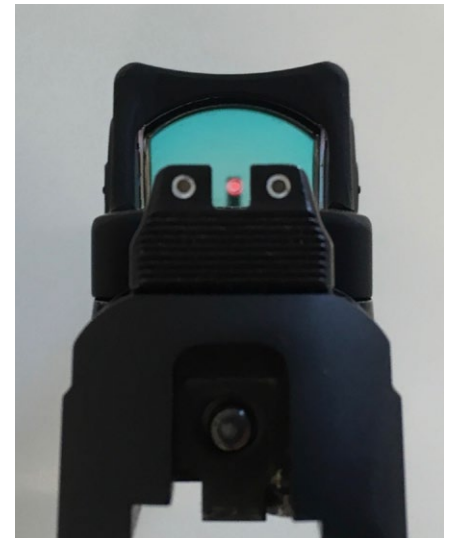
Visierbild mit eingeschaltetem RMR. Gut zu erkennen ist die blaugrüne Tönung der Linse.
