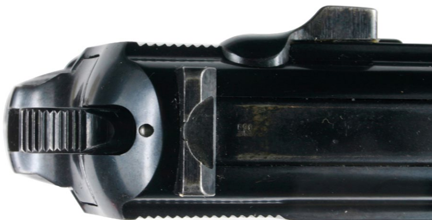
Blick auf das im Bereich der Griffrielen abgesetzte Verschlussstück und die schlanke Kimme
