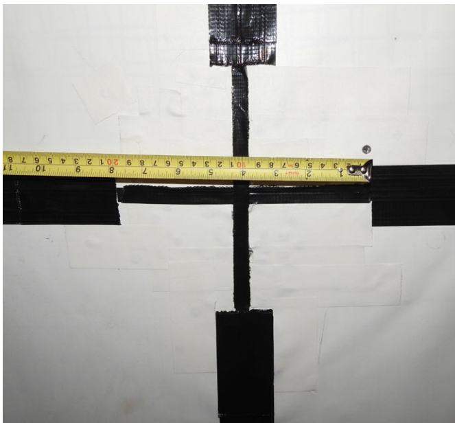
Vermessung und Abgleich der tatsächlichen Trefferkoordinaten mit dem vom System erfassten Treffer
