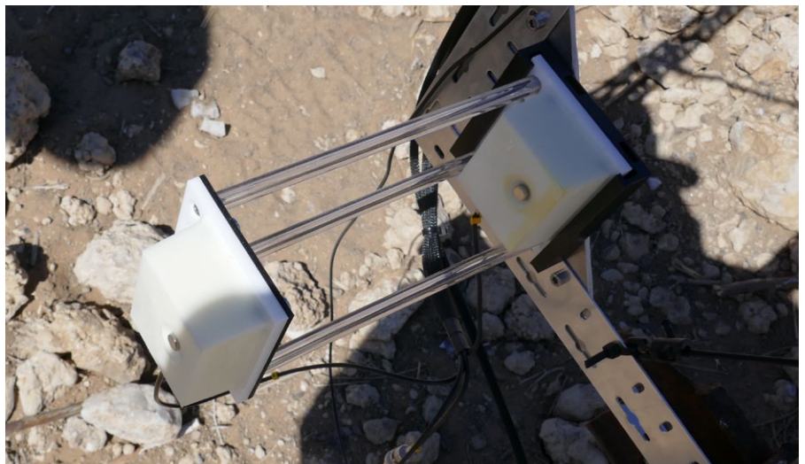
Doppelsensor für die Bestimmung der Geschwindigkeit im Ziel
