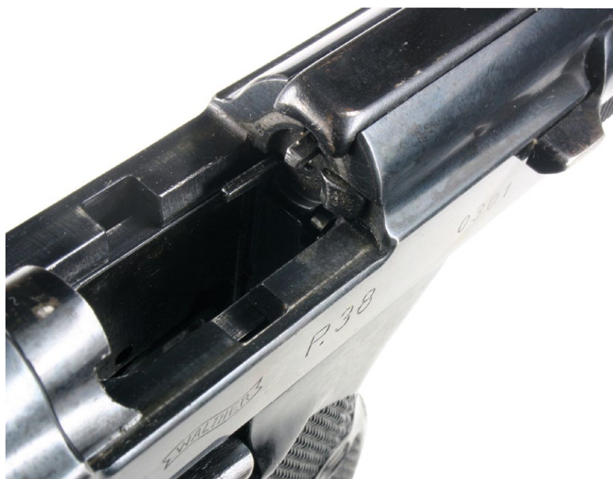
Blick auf die verdeckte Auszieherkralle, wie sie nur bei der Nullserie für den Truppenversuch vorkam – eine absolute Rarität.
