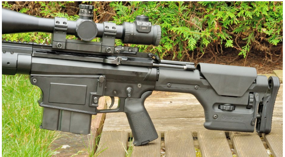
Der Ladehebel ist von beiden Seiten bedienbar und geht so weit zurück wie ein normaler AR-15-Ladehebel auch. Das erlaubt den Anbau handelsüblicher AR-15 Schäfte. Im Schuss bewegt sich der Ladehebel etwa vier Zentimeter. Der Verschlussfang und der Magazinhalteknopf sind von beiden Seiten bedienbar.
