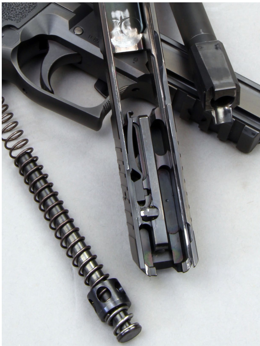
Der Verschluss besitzt zur Gewichtsersparnis Ausfräsungen.
