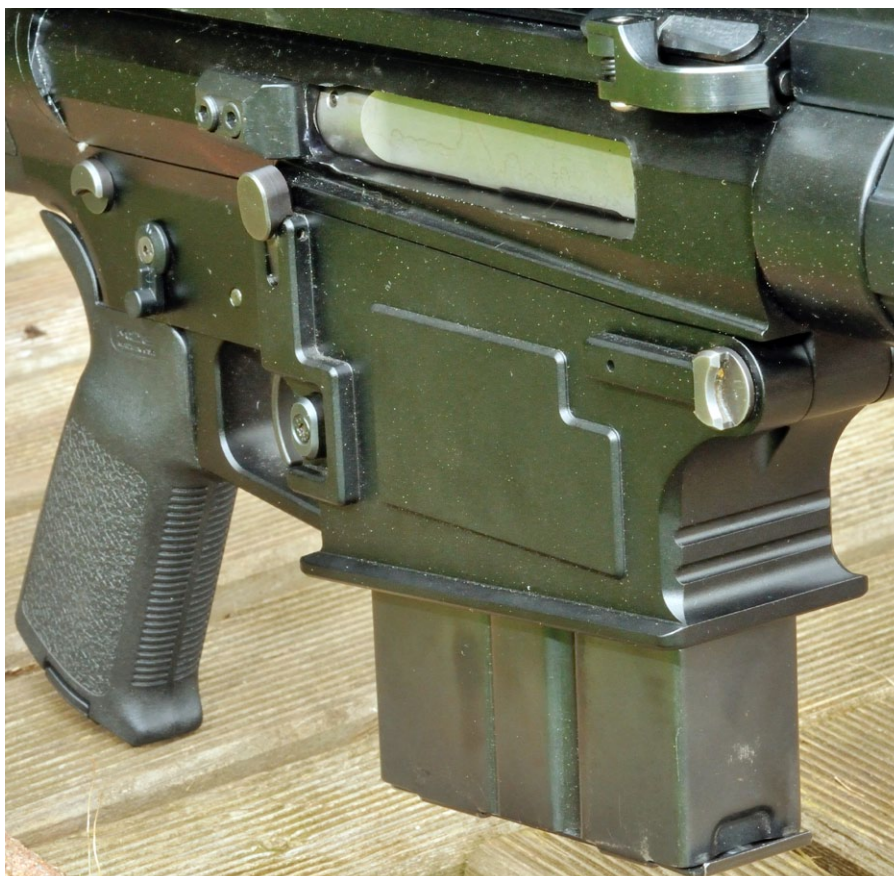
Der Haltebolzen kann dank seiner Kopfform leicht mit dem Fingernagel oder einem Werkzeug gezogen werden.
