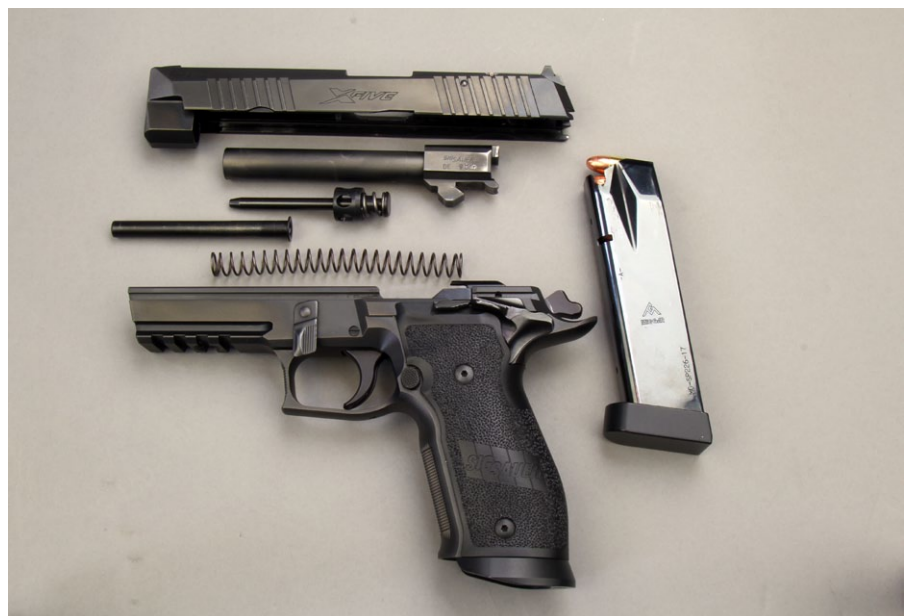
Beim Teilerlegen gibt es keine Überraschungen. Die Schließfeder ist mehrteilig.
