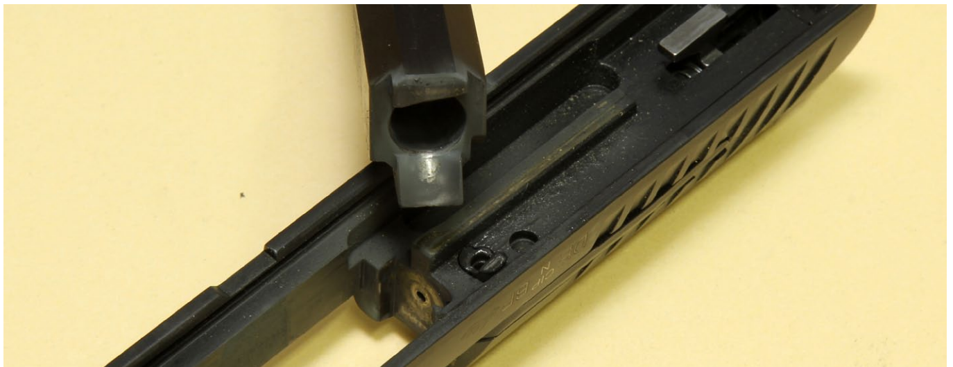
Auch im Verschluss und beim Lauf hält sich die Verschmutzung in Grenzen
