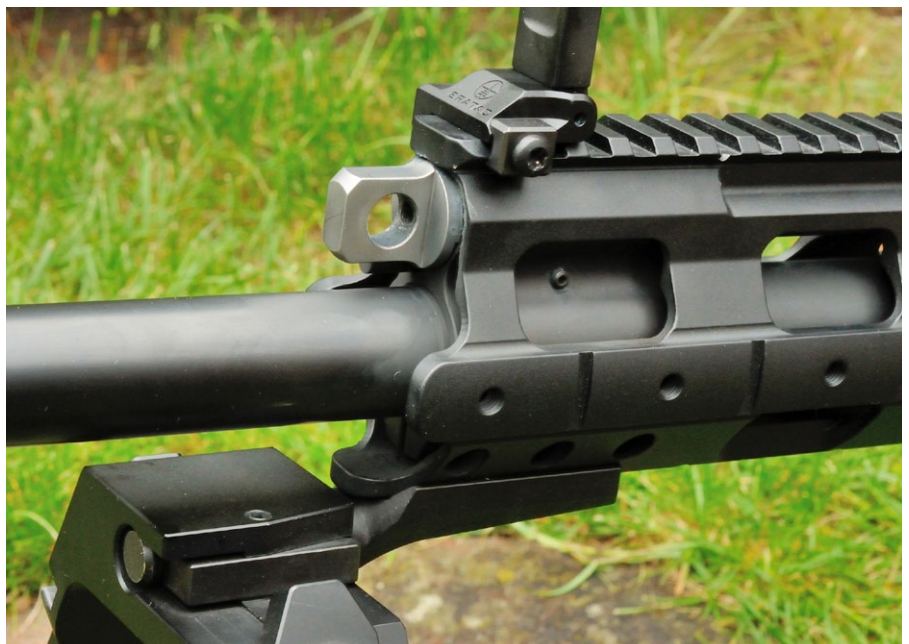
Die Gasentnahme hat drei Positionen und eine Sperrstellung. Sie arretiert sauber. Der Einstellwiderstand könnte etwas höher sein.
