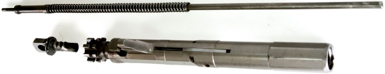
Der short-stroke Piston drückt beim Repetieren etwa 8 cm lang gegen den Verschluss. Er ist in einer Buchse schwingungsarm geführt
